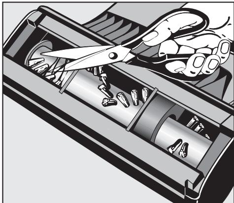
Om handturboborsten är igensatt av smuts inuti borsten kan den öppnas. Större delar som sugits in kan då enkelt avlägsnas.
